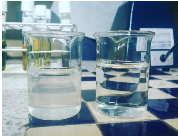
รูปที่ 4.3 น้ำเสียก่อนเข้าระบบ(ซ้าย) และน้ำเสียที่ผ่านการบำบัด(ขวา)
